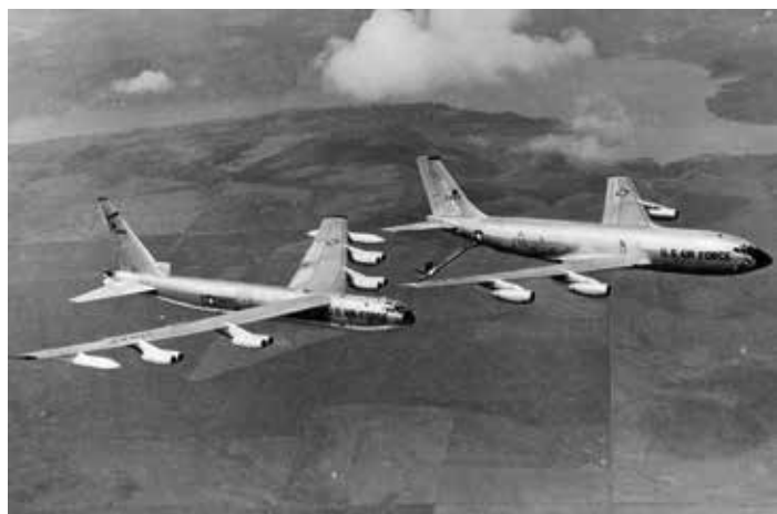
Inicio del repostaje en vuelo de un B-52 y un cisterna KC-135. La manguera mide alrededor de 10 m. Junto con el despegue y aterrizaje supone una maniobra crítica, por ello nunca se realizaba sobre el mar cuando portaba armamento nuclear. Hasta el accidente, se realizó sobre España en 30 582 ocasiones; la mayoría de noche (Foto: USAF).
